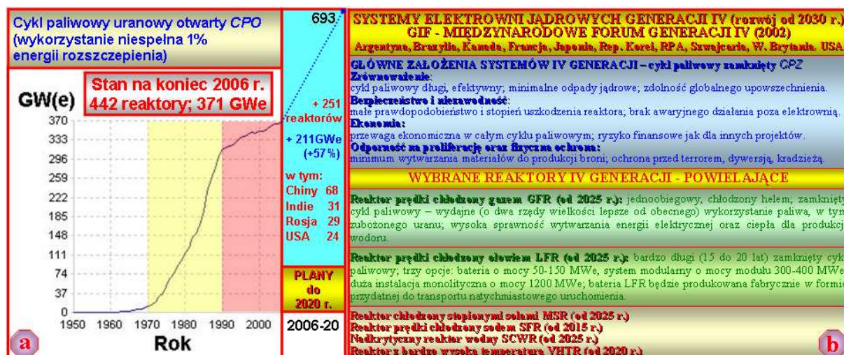
Rys. 8. Energetyka jądrowa: a) prognozy rozwojowe reaktorów o cyklu paliwowym otwartym CPO, b) prace rozwojowe międzynarodowego forum nad IV generacją reaktorów powielających o cyklu paliwowym zamkniętym CPZ, wykorzystujących prawie 100% energii rozszczepienia [14, 15].
